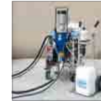
Maschinenausstattung: Feinputzmaschine und mobile ReguTec 3 Einheit
